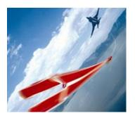
Créée en 1957, la société SECAPEM développe des cibles aériennes remorquées pour l'entraînement des Forces armées. La TAXAN est un système de cible utilisé par les armées pour l'entraînement au tir canon air-air et sol-air. Le système est conçu pour être remorqué par un avion et emporté dans un conteneur avant le déploiement. La cible TAXAN est équipée d'un système de scoring acoustique temps réel.
